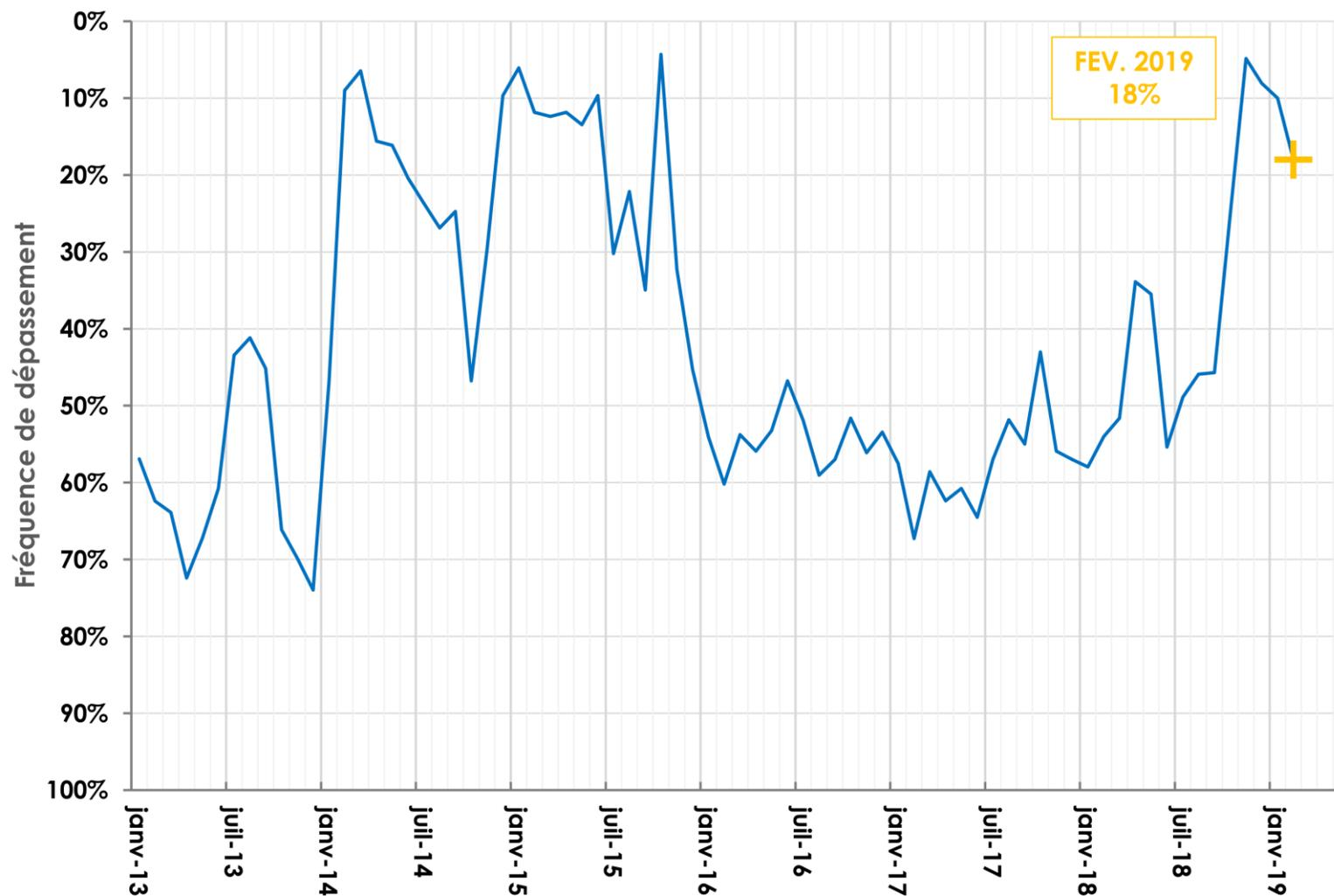
Variation de l'indice statistique des niveaux piézométriques de la nappe (moyenne mensuelle des fréquences de dépassements), calculé sur la période couvrant janvier 2013 à l'actuel. Les observations sont issues des réseaux de surveillance du SYMCRAU et du BRGM.
