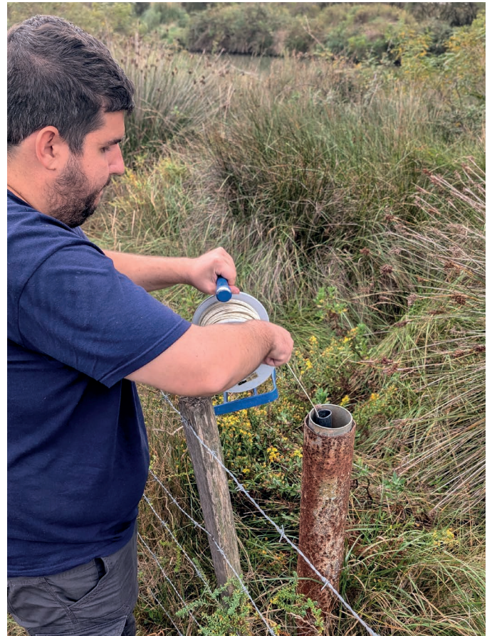
Prise de mesures sur un piézomètre à Mas Thibert Crédits SYMCRAU
